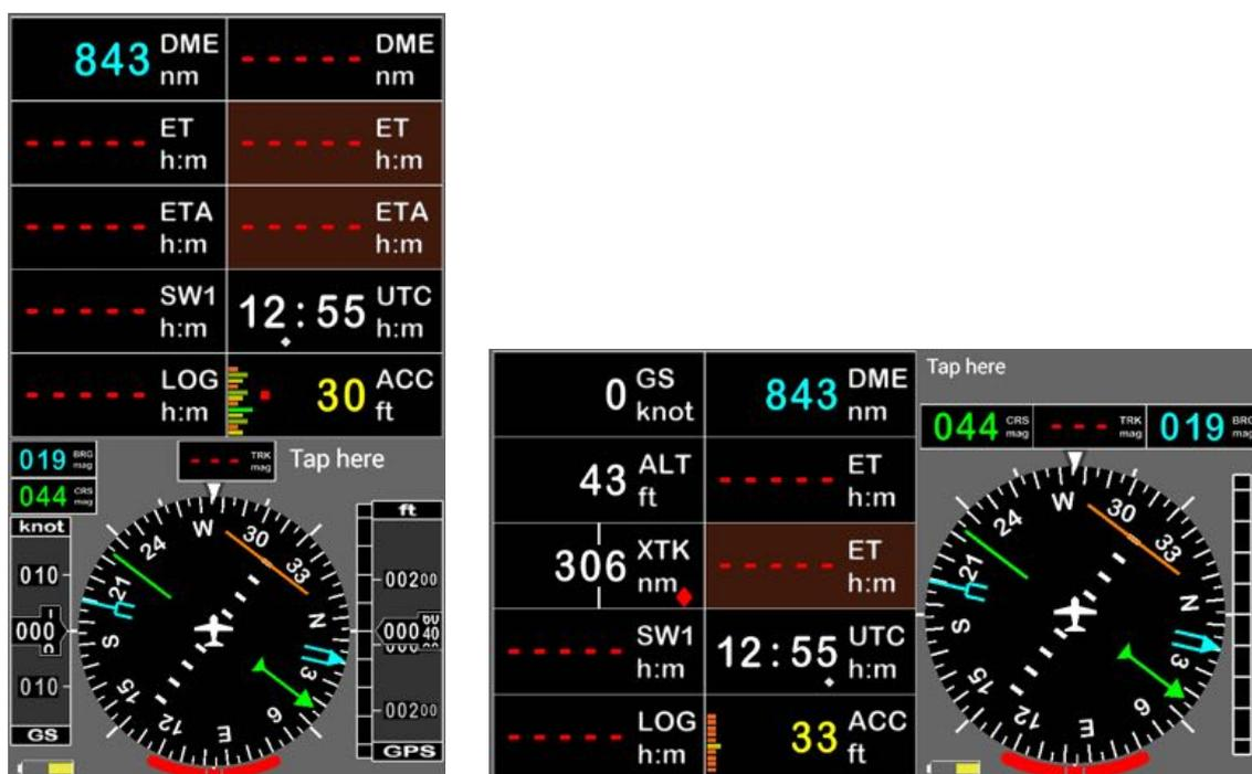
*Note: Tous les boutons sont modifiables et paramétrables ce qui permet au pilote d'afficher ce qu'il souhaite voir. Pour les modifier ou les paramétrer -> **Appui long** sur le haut de la rose du compas.*
