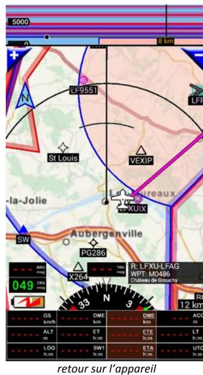
Note : Dès que l'appareil n'est plus affiché sur l'écran, une **bulle bleu** indique la direction de l'appareil. Un **appui court** sur la **bulle bleu** renvoie à l'appareil.
