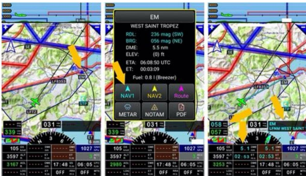
**CRS** : Gisement du point ou cap à suivre pour l'atteindre le point, à partir de l'appareil
