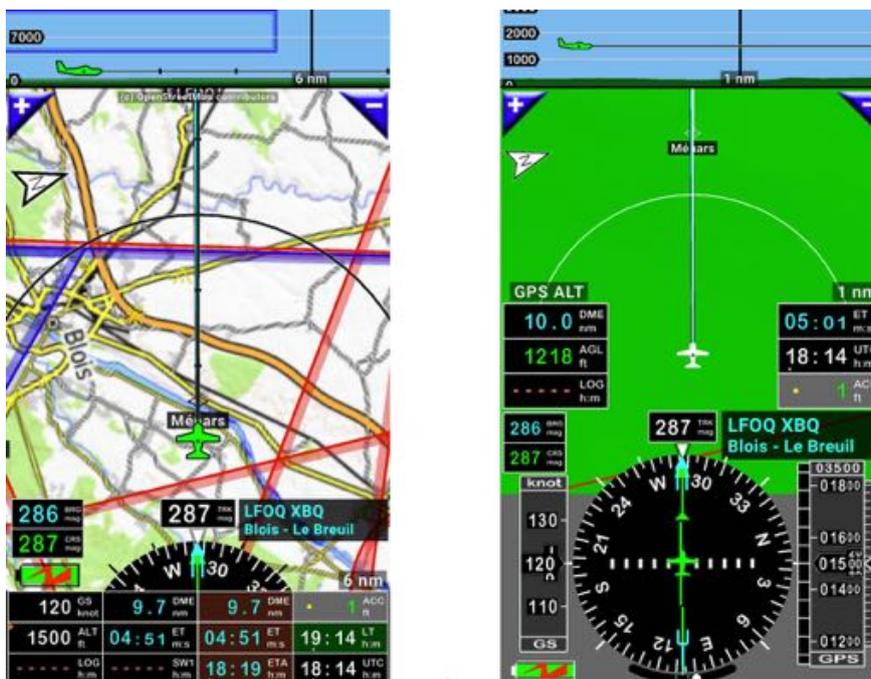
Si l'appareil est jaune sur la moving map, ou la surface est jaune sur l'écran terrain, la hauteur sous l'appareil est comprise entre 500 pieds et 1 000 pieds
