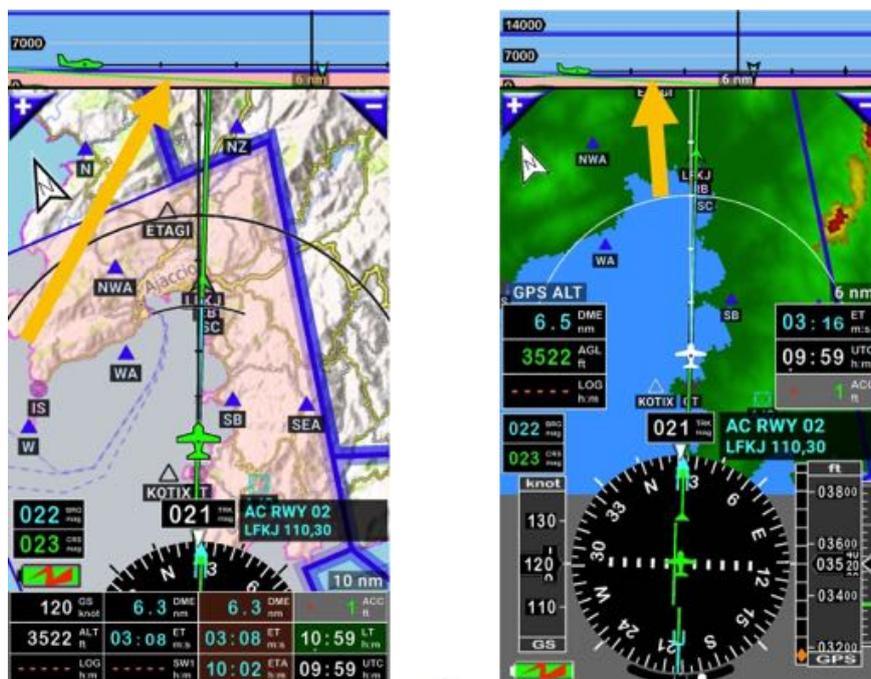
Le plan d'approche étant activé, des alertes retentissent en fonction de la position de l'appareil.
