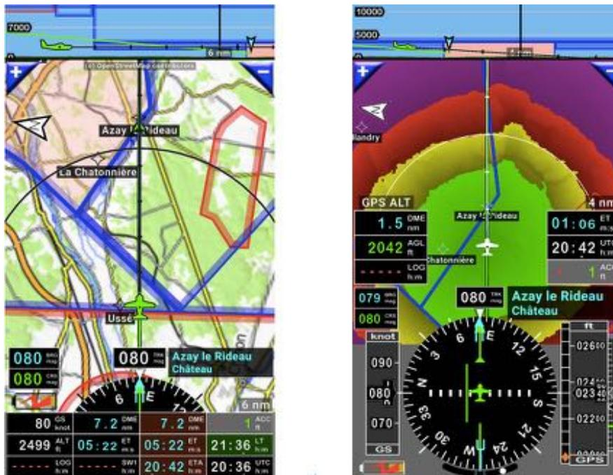
Les plans d'approche sont matérialisés par les lignes vertes sur les cartes et dans les coupes verticales.
