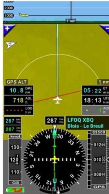
Si l'appareil est rouge sur la moving map, ou la surface est rouge sur l'écran terrain, la hauteur sous l'appareil est inférieure à 500 pieds
