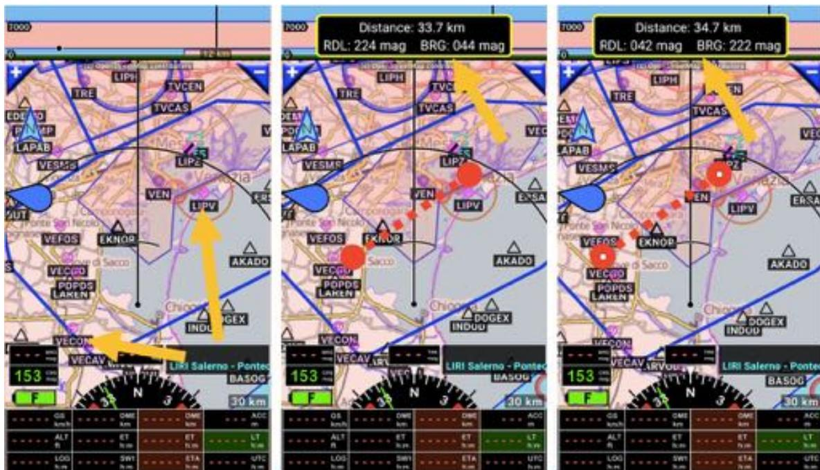
**Note** : Les relèvements indiqués BRG Bearing et RDL Radial dépendent de l'ordre avec lesquels les doigts sont posés sur l'écran. Quel est le premier doigt qui a été au contact ?
