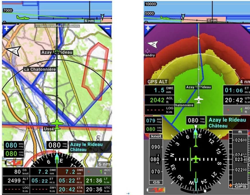
Il percorso di discesa appare nel taglio verticale. Funzione utile per i piloti che vogliono controllare precisamente la loro discesa.
